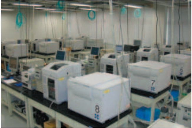
数千種類の細胞内代謝物質を一斉に測定できるCE/MS。先端生命科学研究所が開発したメタボローム研究の新兵器。
